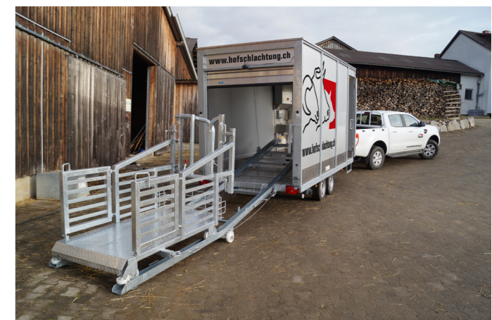
Mischa Hofers Schlachthanleger mit ausgefahrter Betäubungsbucht.
